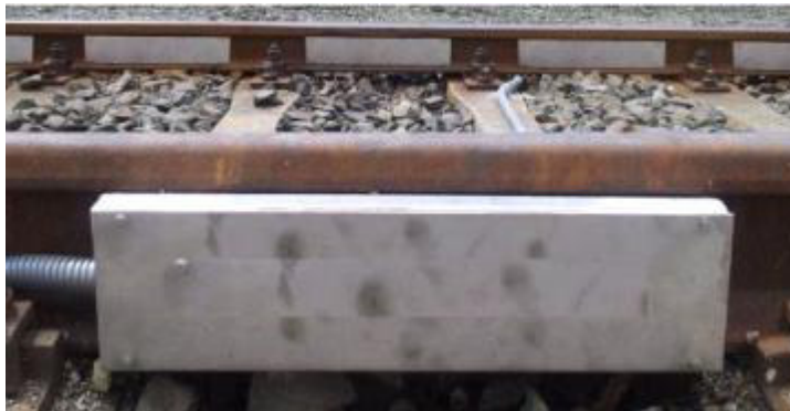
Bild 1: Flachstellenortungsanlage / Einfache Montage am Gleis
